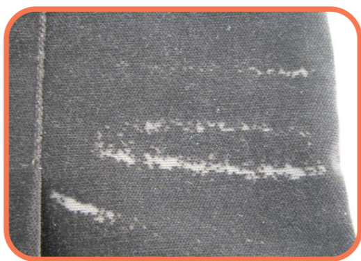
前側の両腰付近のパイルが脱落し、基布が露出している
