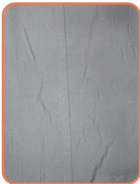
生地全体に波打ちが生じている
