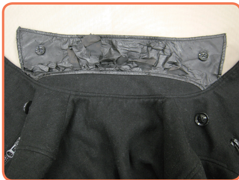
合成皮革のポリウレタン樹脂が劣化し、剥離している
